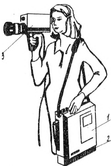
Общий вид видеомагнитофона с камерой: 1 - видеомагнитофон; 2 - батарея; 3 - телекамера
