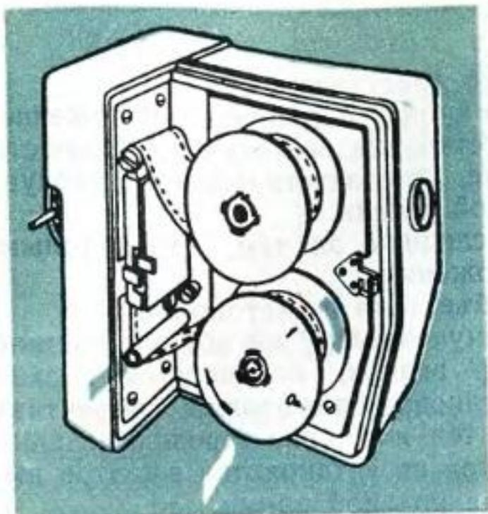
счетчика, перематывать пленку до тех пор, пока указатель счетчика не встанет против отметки «7,5». При этом перематывается пленка, засвеченная при зарядке камеры.
