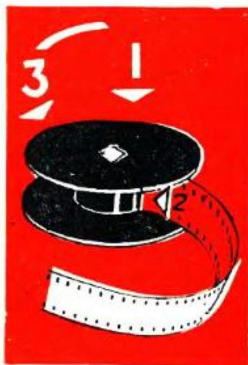
Киноплёнка обычно продается намотанной на бобину, имеющую в центре одного фланца четыре выреза, в центре другого — три. Однако в продаже бывает плёнка, не намотанная на бобину. В этом случае зарядку нужно производить в темноте в следующем порядке:
