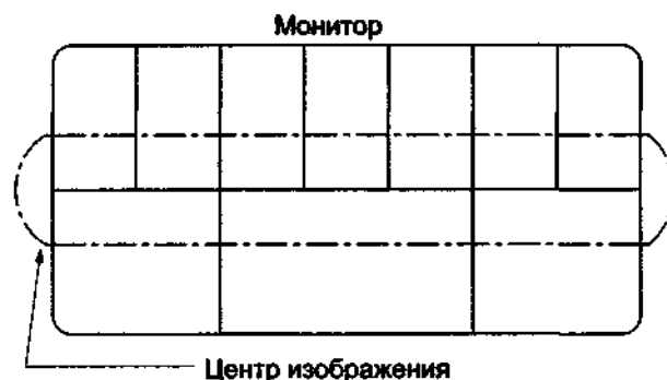
Рис. 5.16. Схема расположения цветных полос в положении «СТОП-КАДР»
