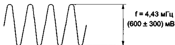
Рис. 4.5. Осциллограмма сигнала в контрольной точке X11. Проверка синхросигнала в режиме «ЗАПИСЬ»
