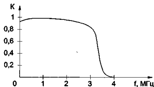
Рис. 2.5. Амплитудно-частотная характеристика фильтра низких частот 3.1-Z1
