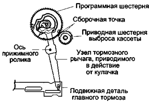
Рис. 6.35. Общий вид ведущей кулачковой передачи, шестерни привода выброса кассеты и тормозного рычага
