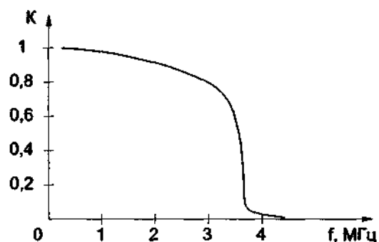
Рис. 3.9. Амплитудно-частотная характеристика фильтра низких частот Z1
