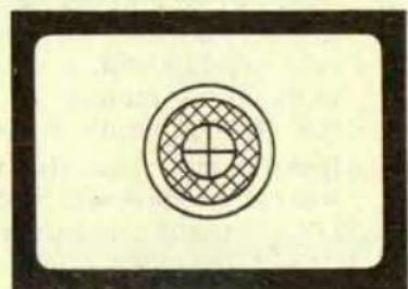
ниях диафрагмы больше 4. Здесь, а также при микро- и макросъемках, для наводки на резкость следует пользоваться кольцевым полем матовой поверхности.
